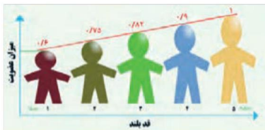
شکل ۲۲- تعیین میزان بلندقدی افراد با منطق فازی
